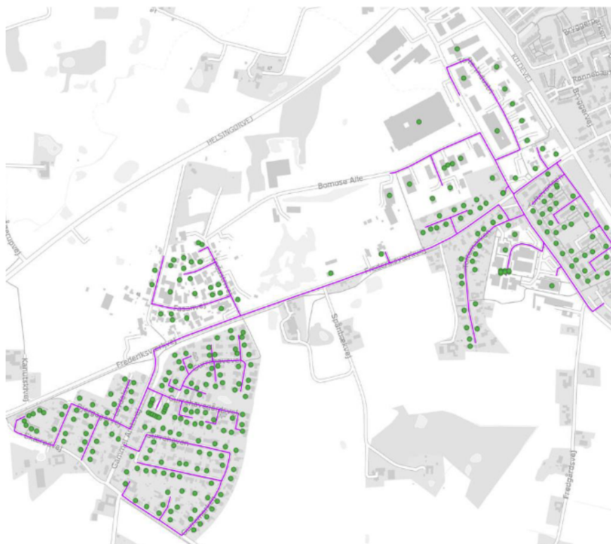
Figur 8 Forslag til fjernvarmeforsyning Helsingør Vest
